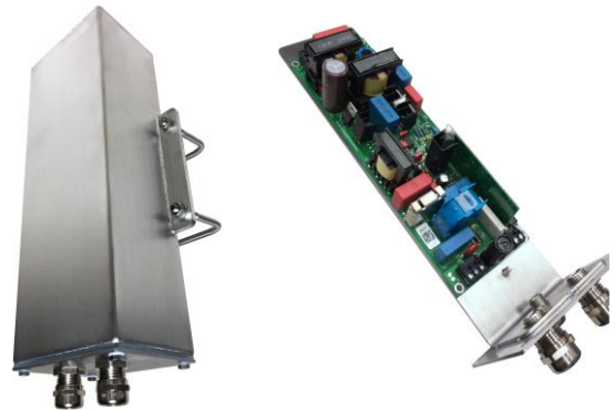
Optional: Industriefestes Vorschaltgerät im robusten Edelstahlgehäuse mit Entlüftungsmembran (IP 67)
